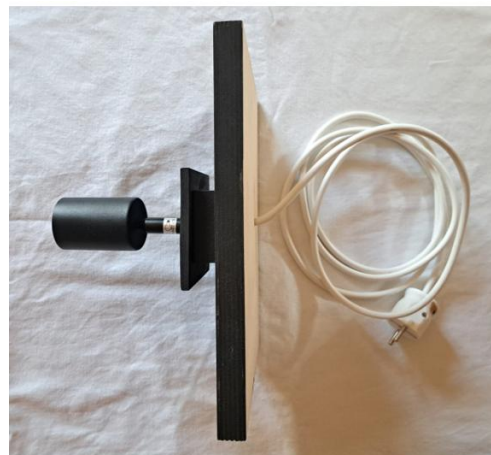
Abbildung 29: Aufbau der Leuchten, Variante E27 (eigene Aufnahme)
