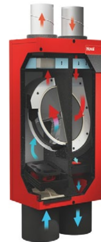
Abb. 17 : Lüftungsgerät mit Wärme- und Feuchterückgewinnung, Luftleistung 300 m³/h Abmessung: 100 x 56 x 37 cm Quelle: Hoval AG
