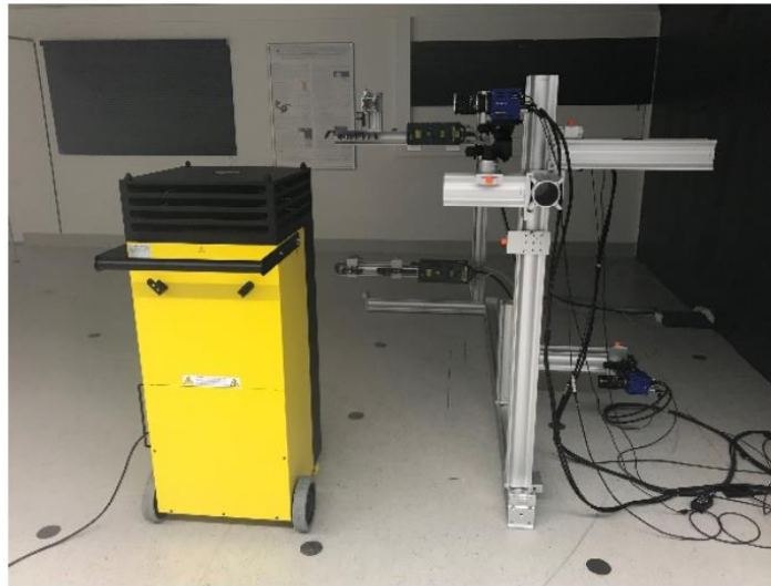
Abbildung 3: Experimenteller Aufbau mit Raumlufreiniger, zwei DoppelpulsLasern und 4 sCMOS Kameras (links) und Aufnahme während der Messung mit PIV (rechts)
