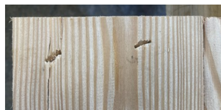
Abb. 21: Eindringtiefe der Klammern bei zu hohem Druck
