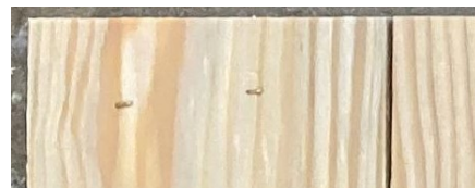
Abb. 22: Eindringtiefe der Klammern bei zu korrektem Druck
