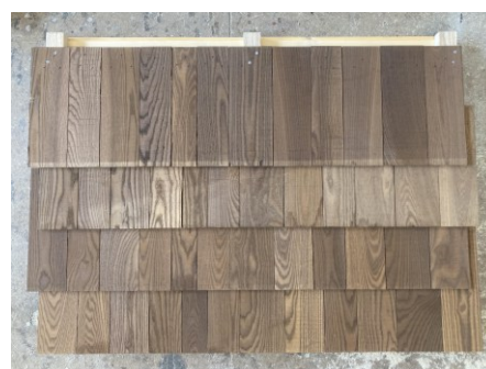
Abb. 19: fertiges Schindelmodul mit Schindelelementen aus Thermoesche
