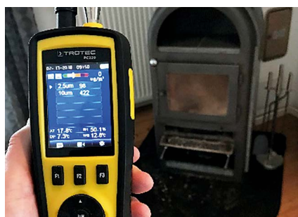
Abb. 2: Tendenzielle, indirekte Ermittlung der Partikelanzahl (PM2,5 und PM10). Es sollte innen und außen gemessen werden (Messgerät Fa. Trotec)
