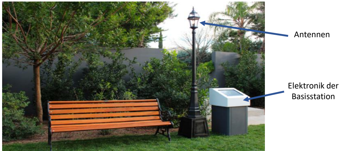
Abb. 7: Stadtmöbel mit getarnter Small Cell, geeignet für alle LTE/5G Frequenzbänder [15]
